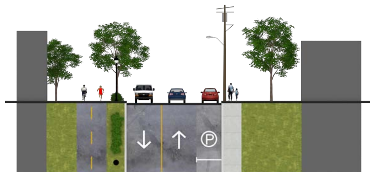
DEUX VOIES DE CIRCULATION, UNE VOIE DE STATIONNEMENT ET UNE PISTE CYCLABLE EN SITE PROPRE
